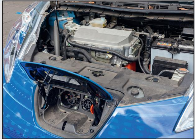
Der Elektromotor als Antriebselement hat eine zentrale Rolle, wobei der Begriff Elektromotor nicht ganz korrekt ist, da das Antriebselement auch als Generator eingesetzt werden kann und bei der Rekuperation auch entsprechend verwendet wird.
